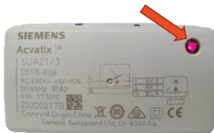
Voyant témoin d'ouverture de la V2V
